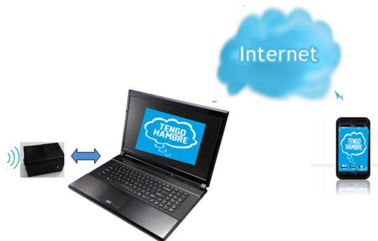
Figura 2. Sistema de recepción, comunicación con el computador y envío de mensajes de texto
