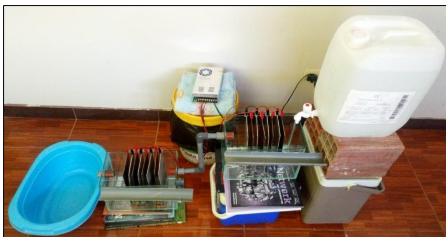
Figura 1. Reactor de tipo continuo / tratamiento de plomo / matriz agua
