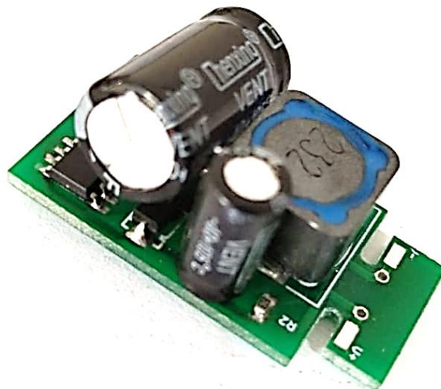
Figura 7. Fotografía del driver, cuyos componentes están soldados en un solo lado de la tarjeta
